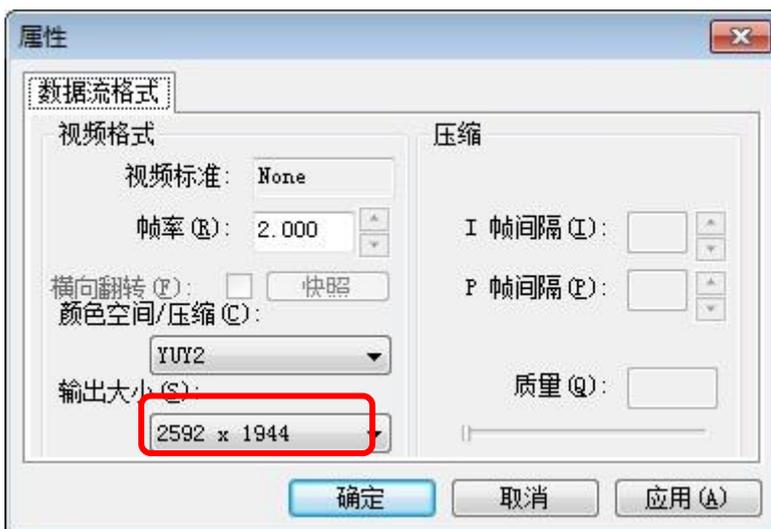
就会出现
